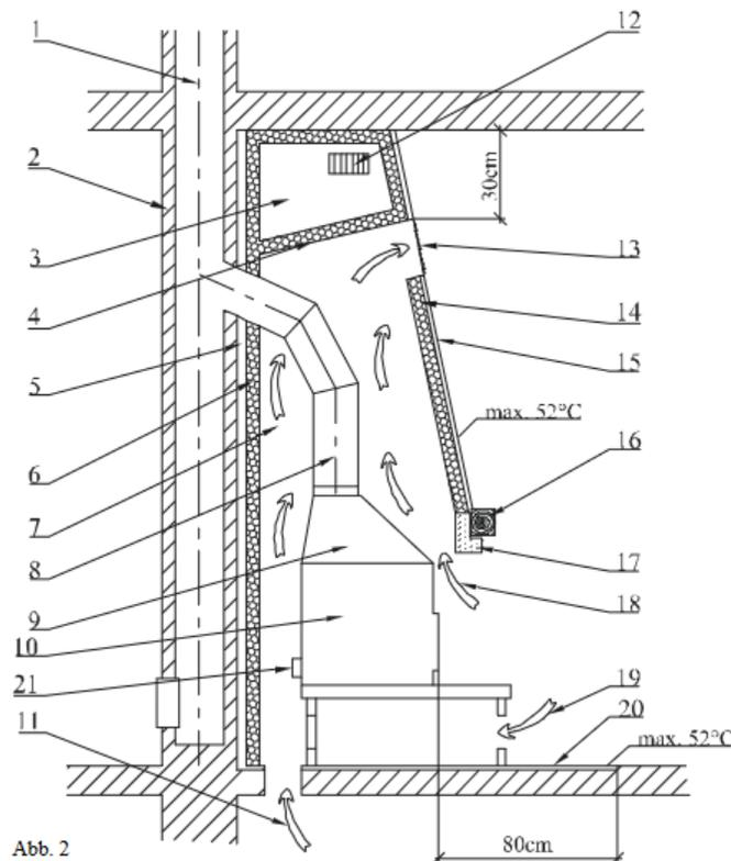
Vertikaler Schnitt eines Einmantel-Kamins mit geschlossener Feuerstätte.
